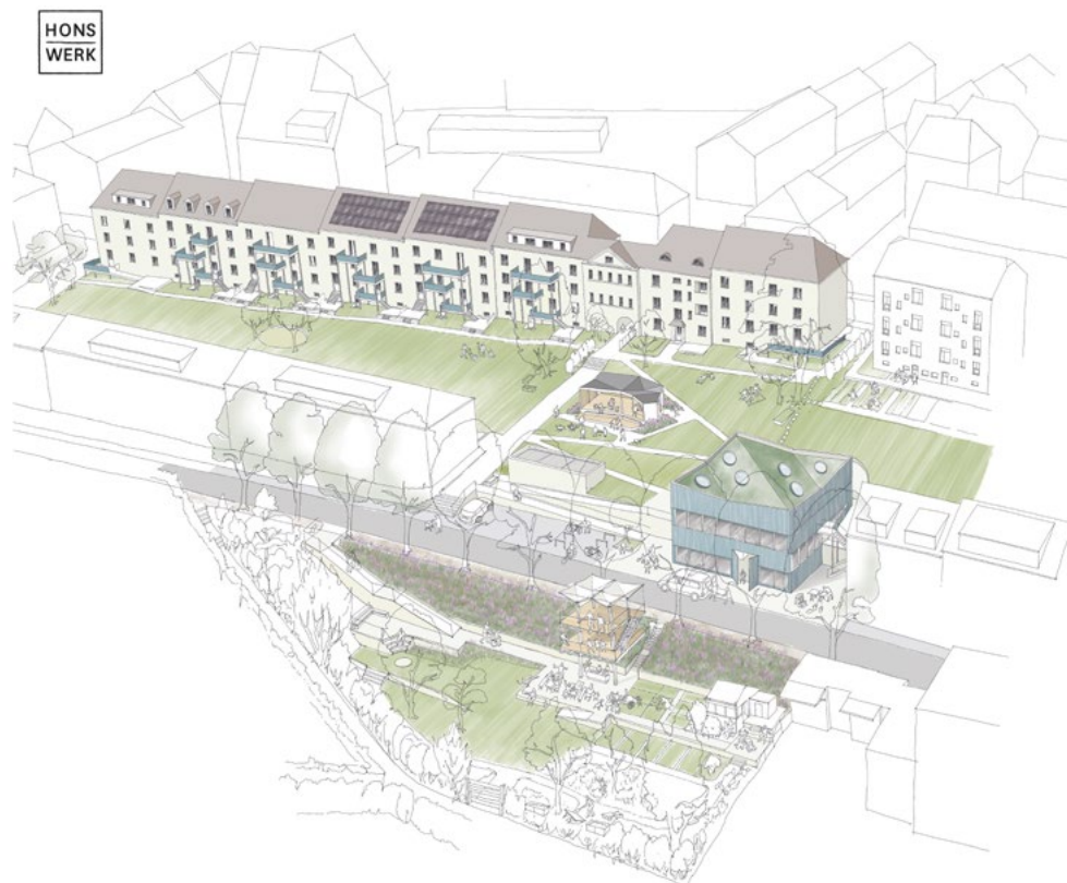
Abbildung 1: Gesamtansicht des HONSWERK: Die Arbeitersiedlungshäuser werden kernsaniert, gedämmt und bekommen Balkone zum grünen Innenhof. Im Vordergrund das dreieckige Grundstück des Stadtteilgartens mit Aussichtsterrasse und dahinter der Neubau der HONSWERKSTATT sowie der Gemeinschaftspavillon. Illustration: Robert Winterhager/Urbane Nachbarschaft Honsberg.
