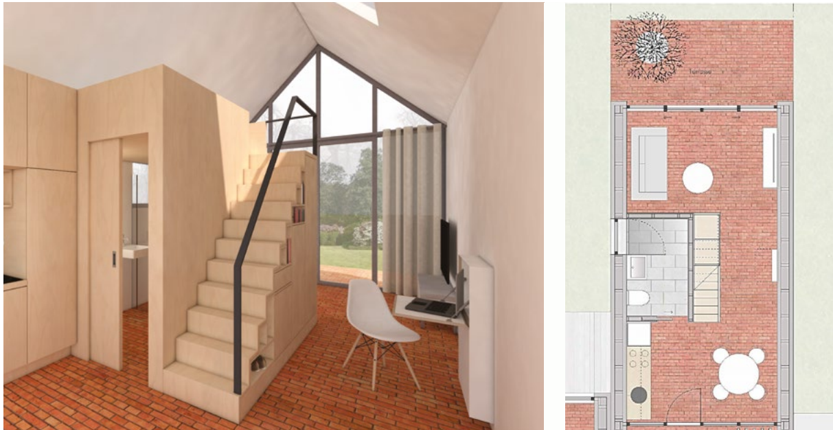
Abbildung 5: Haus mit 33m² Wohnfläche, ebenfalls mit einem erhöht angeordneten Schlafbereich über der Nasszelle: Typ C. Links: Innenansicht des Hauses. Rechts: Grundriss von Erdgeschoss mit Terrasse. Grafik: Pax Brüning Architekten, Beitrag im Wettbewerb Zukunftsstadt.
